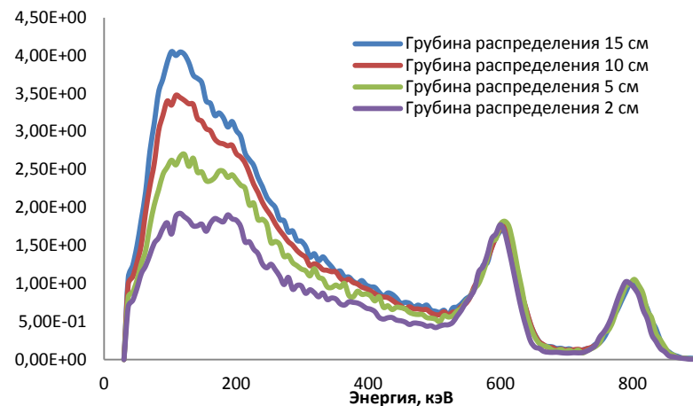
Расчетные аппаратные спектры для различных глубин распределения Cs 137 и Cs 134 в почве с учетом критического радиуса
