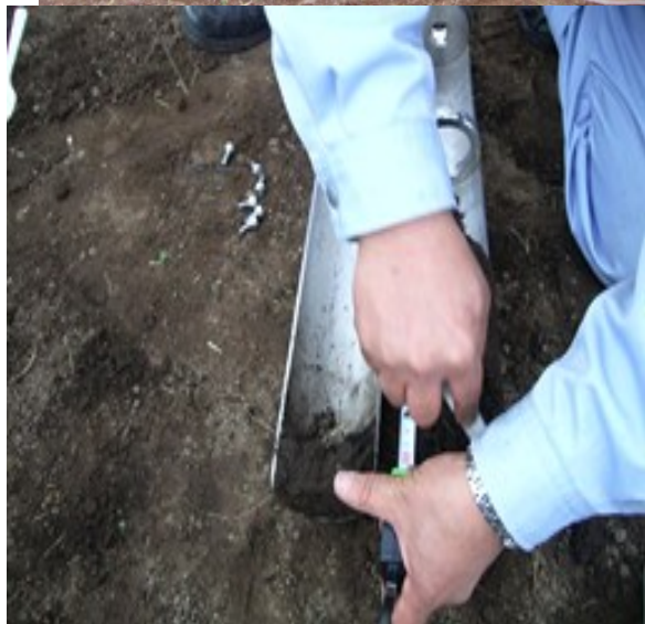
Испытания и отбор проб на реперных площадках с глубиной вспашки 5 и 10 см
